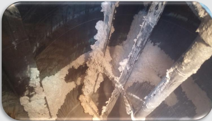
משקע פולימרי בריאקטור של חברה לייצור חומרי בניין
